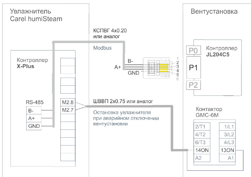
Подключение производится двумя кабелями:
